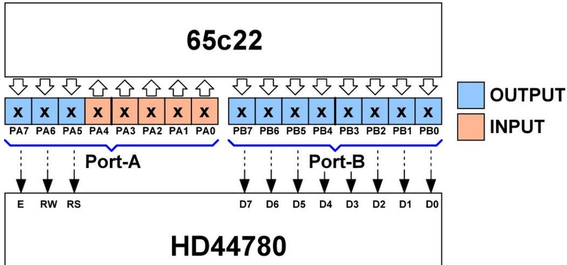
Abbildung 197 - Die Ansteuerung des LC-Displays über Port A und Port-B
