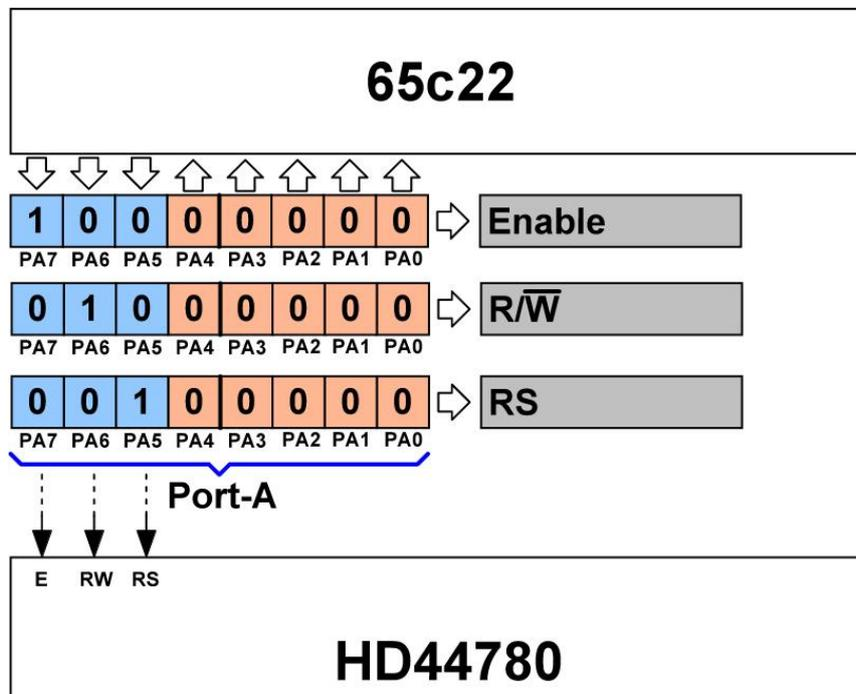
Abbildung 198 - Die Konfiguration des LC-Displays über Port A
